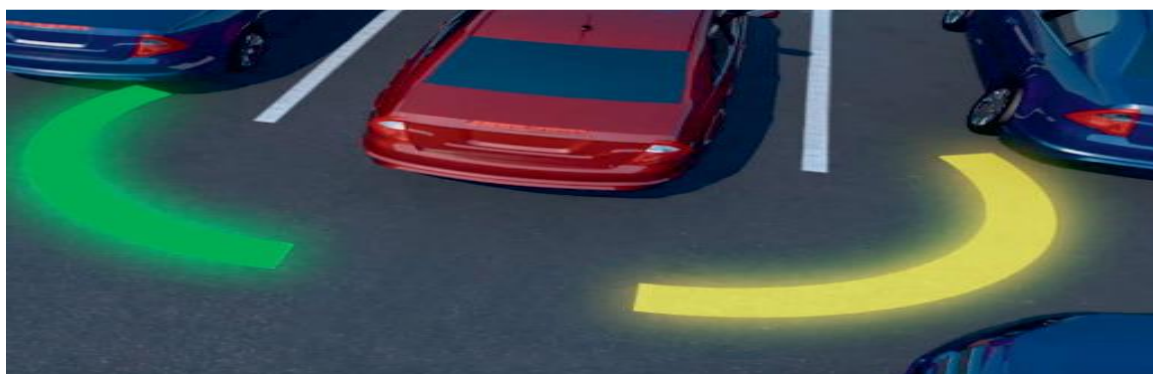
Slika 5. Sistem prepozna dolazeće vozilo i po potrebi zaustavi automobil
