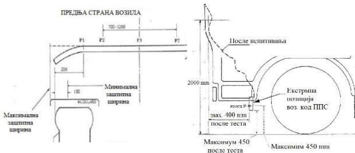
Слика 12. Димензиони лимити уређаја за заштиту од чеоног подлетања, [6]
