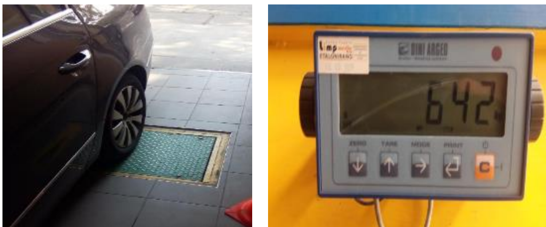
Slika 1. Merenja mase na zadnjoj osovini vozila, displej za prikaz težine
