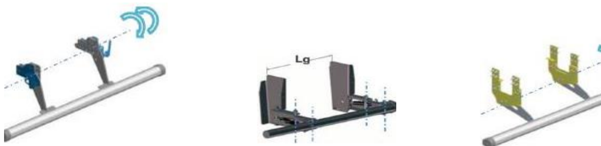
Слика 6. Примери уређаја за заштиту од задњег подлетања који се могу ротирати, [3]
