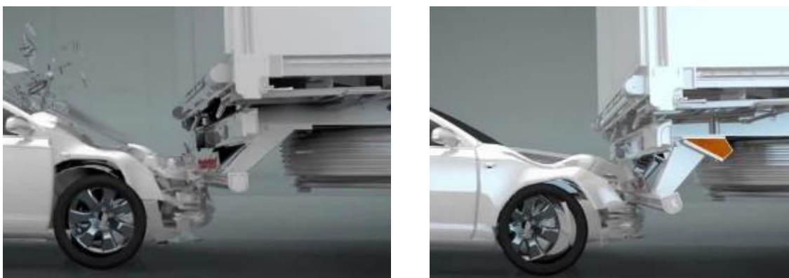
Слика 5. Примери уређаја са заштитом од подлетања са задње стране, [12]
