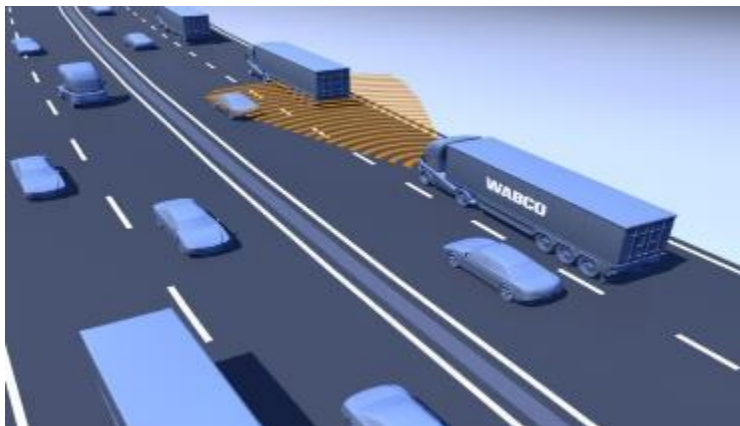
Слика 5. Collision Avoidance System – CAS(извор: www.nts.gov , 27.09.2016)
