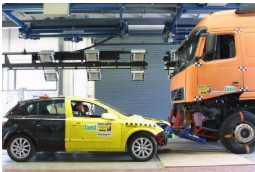
Слика 13. Развој метода испитивања уређаја за заштиту од чеоног подлетања, [6]
