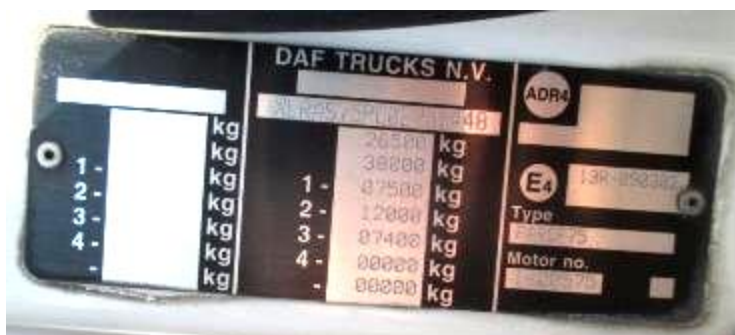
Slika 1: Identifikaciona pločica troosovinskog teretnog vozila. Najveća dozvoljena masa vozila je 26,5 t i veća je od dozvoljenih 26 t za troosovinska vozila u R. Srbiji. Najveće dozvoljeno osovinsko opterećenje pogonske osovine je 12 t i veće je od u R. Srbiji dozvoljenih 11,5 t
